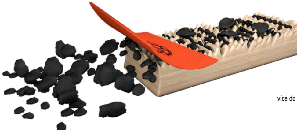
Obr. 8 - Při otírání neošetřeného povrchu zatlačujeme drobné nečistoty ještě více do útrob povrchu, odkud je již téměř nelze odstranit.
