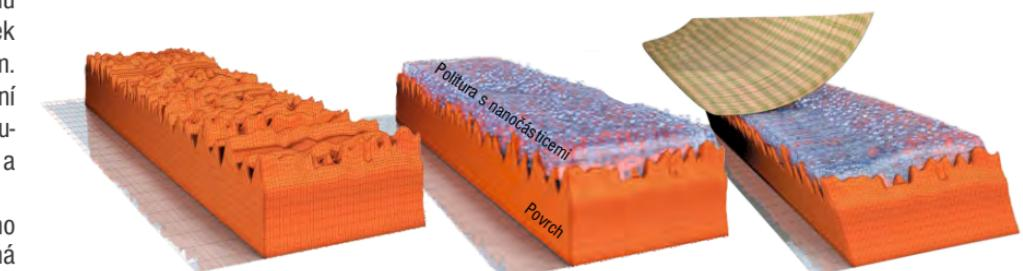
Obr. 5 - Povrch po vyčištění
