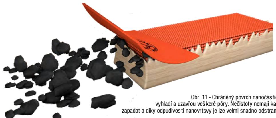
Obr. 11 - Chráněný povrch nanočástice vyhladí a uzavřou veškeré póry. Nečistoty nemají kam zapadat a díky odpudivosti nanovrstvy je lze velmi snadno odstranit.
