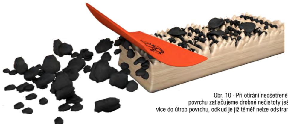
Obr. 10 - Při otírání neošetřeného povrchu zatlačujeme drobné nečistoty ještě více do útrob povrchu, odkud je již téměř nelze odstranit.
