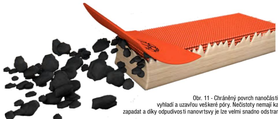
Obr. 11 - Chráněný povrch nanočástice vyhladí a uzavřou veškeré pory. Nečistoty nemají kam zapadat a díky odpudivosti nanovrstvy je lze velmi snadno odstranit.
